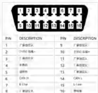
OBD-II连接器引脚图
