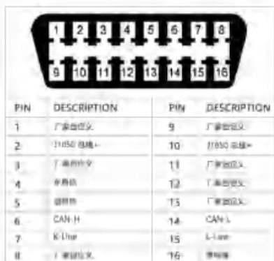
OBD-II连接器引脚图
