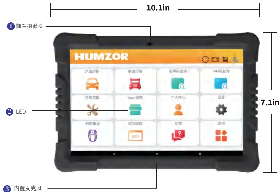
(图2-1 平板诊断设备的前视图)
